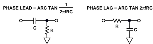
Phase Shift Circuits
