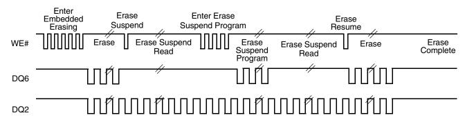
Figure 15.10 DQ2 vs. DQ6
