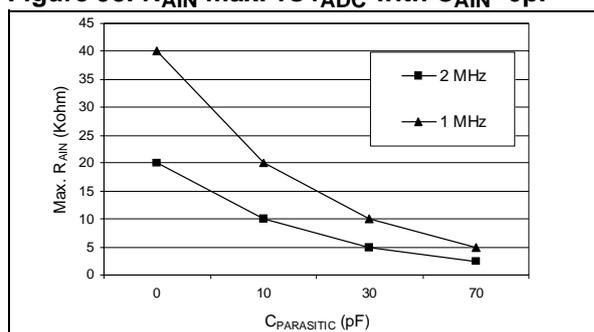
Figure 94. Recommended  $C_{AIN}$  &  $R_{AIN}$  values.<sup>5)</sup>
